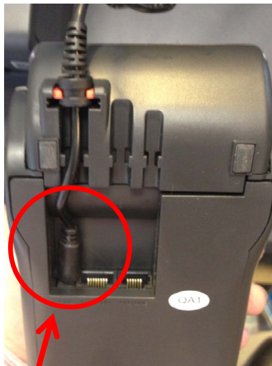
Strømkablet er tilsluttet den nye taletidsterminal
