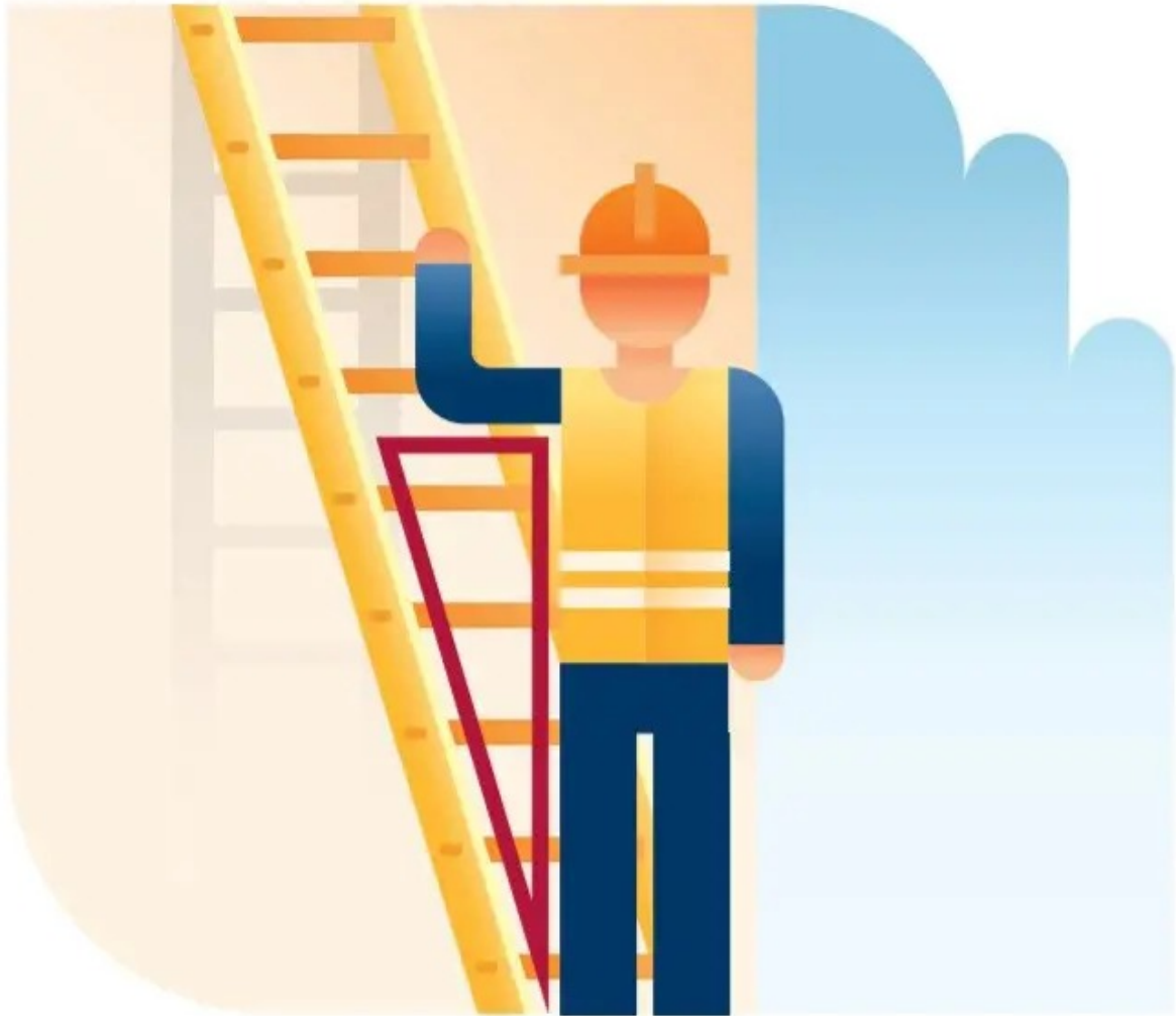
Figur 3 - Stige med 75 grader hældning
